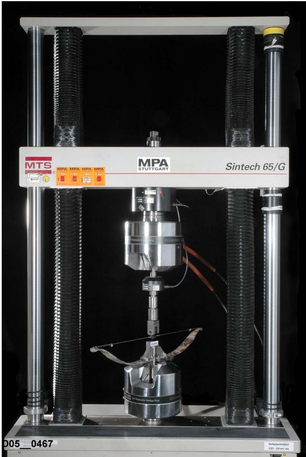
Bild 1: Armbrust-Bogen Exomax bei Auslenkung 0 mm
